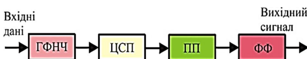
Рис. 2. Схема формування сигналів GMSK: ГФНЧ – гаусівський фільтр низьких частот; ЦСП – цифровий сигнальний процесор; ПП – підсилювач потужності; ФФ – формуючий фільтр
