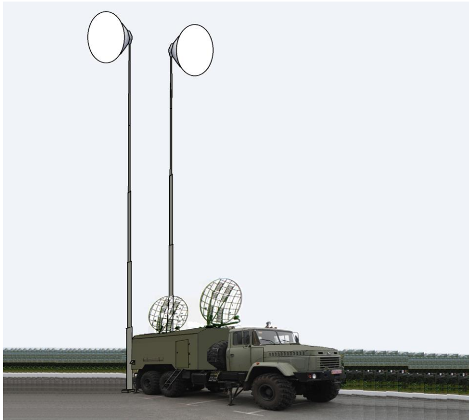
Рис.1. Мобільна цифрова тропосферно-радіорелейна станція у розгорнутому положенні (конструктивний варіант) [3]
