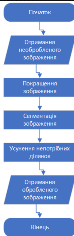
Рис. 1. Блок-схема алгоритму попередньої обробки зображення.
