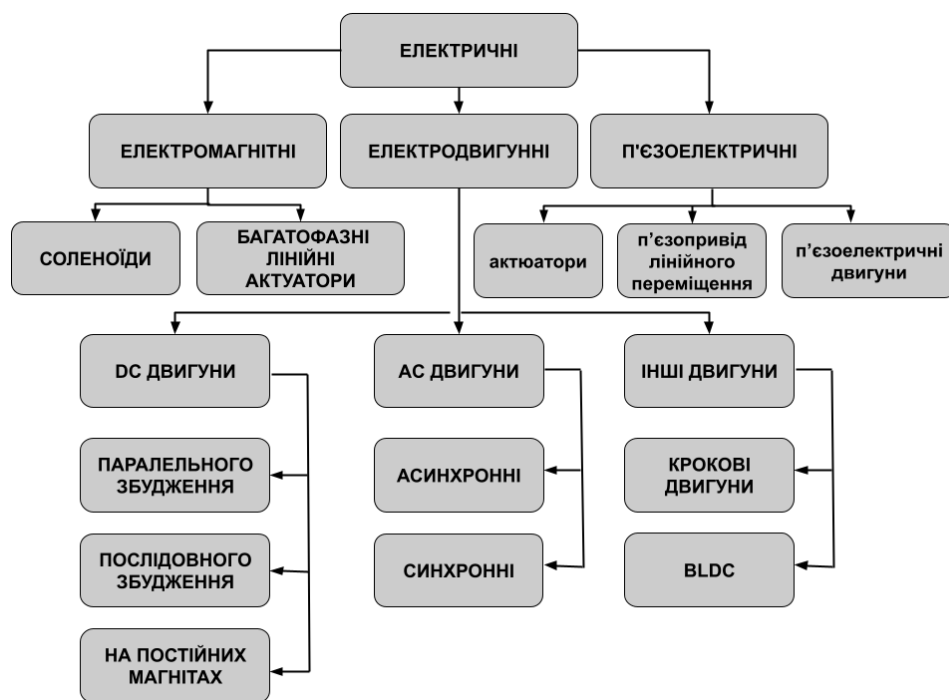
Рис.5. Класифікація типів електромеханічних приводів
