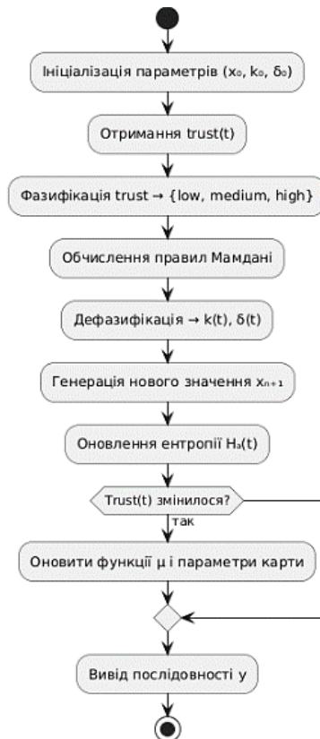
Рис. 4. Алгоритм роботи нечіткого хаотичного генератора випадкових чисел
