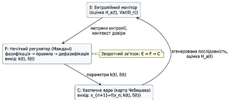
Рис. 3. Структурна модель адаптивного хаотичного генератора з нечітким контуром керування
