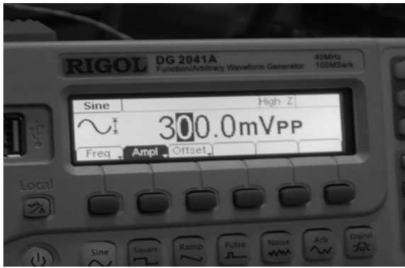
Рис. 7. Размах сигнала генератора 300 мВ, соответствующий напряжению на входах усилителей после делителя
