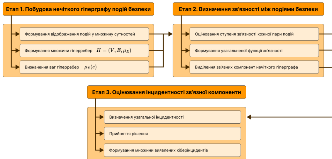
Рис. 1. Схема методу виявлення кіберінцидентів у SIEM на основі нечіткого гіперграфового подання подій безпеки та лінійної моделі інцидентності
