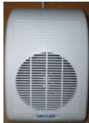
б. Зовнішній вигляд прототипу пристрою вбудованого у заводську точку оповіщення «ВЕЛЛЕЗ 6АС100ПН-2»
