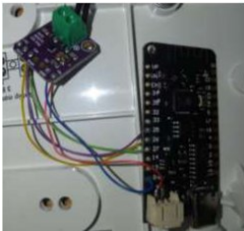
а. Підключення модуля MAX98357A до мікроконтролерної платформи
